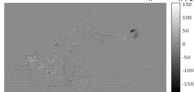
différence avec compensation de mouvement ( I_{n+1} et I_{n+1} reconstruit depuis I_n )
